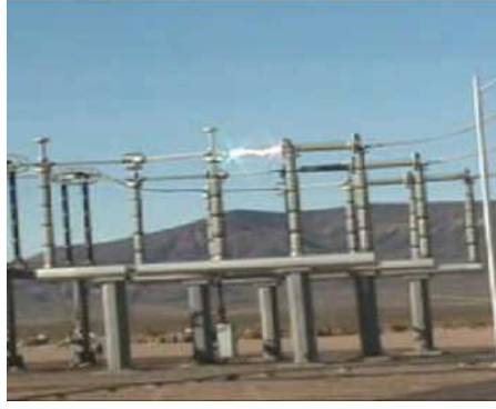
Resim 23.6 500 kV'luk havalı kesicinin açma işlemi sırasında oluşan ark
