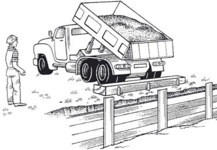
Şekil 33: Araç boşaltılırken takoz kullanılmalıdır 29 .
