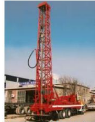
Sondaj makinesi (zemin delgi)
